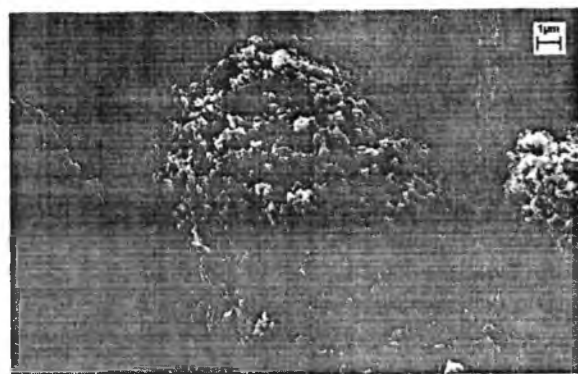
Рис. 3. Мікрофотографія \text{NiFe}_2\text{O}_4 , отримана на скануючому електронному мікроскопі [5].
