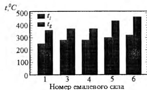
Рис. 6. Значення температури початку розтріскування покриттів ( t_1 ) та температури трансформації стекел ( t_g ).
